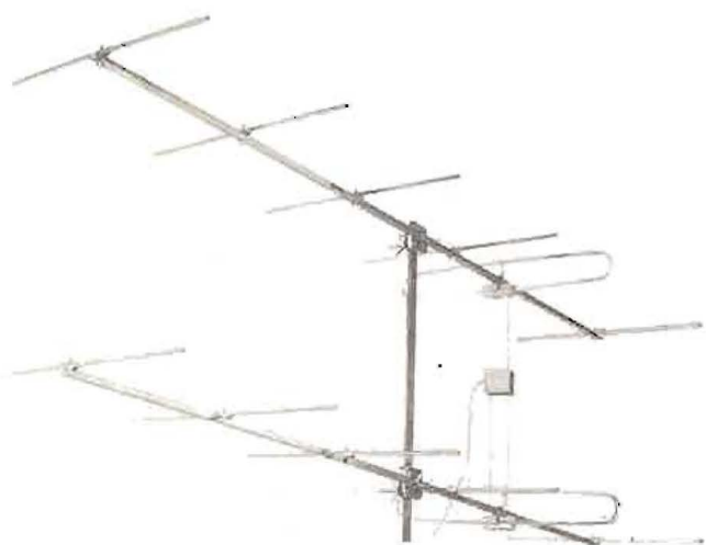
Figura 38. — Aspecto real del montaje de una antena del tipo "Stacked", formada por dos antenas de 6 elementos cada una, con ganancia de 9,5 dB y eficacia direccional de 25 dB. (Cortesía EMMA-FUBA.)
