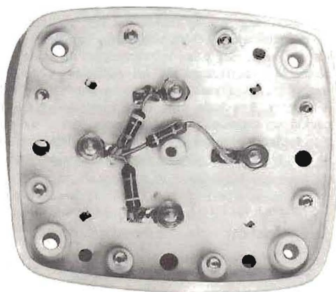
Figura 60. — Caja de derivación para instalación colectiva con cable de línea de 60 \Omega .
