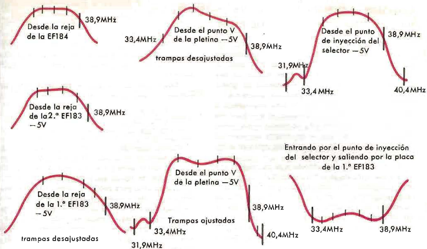
Figura 49. — Curvas indicativas del ajuste que debe obtenerse en una pletina como la indicada en la figura anterior.
