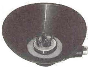
Figura 10. — Conexión especial para la MAT al TRC. Obsérvese la ventosa para aislar el borne de la parte exterior.
