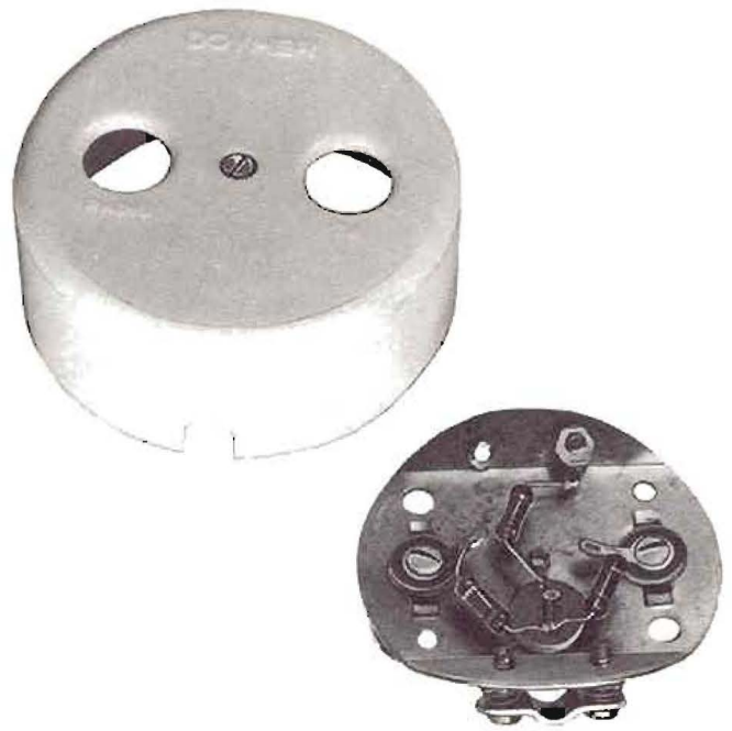
Figura 62. — Detalle de una caja de toma doble en la que la línea no continúa con resistencia para final de línea.
